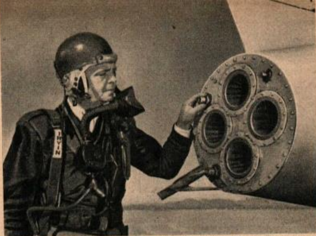
Le tube qui sort sur le côté en bas et à gauche sert à la vidange rapide du combustible restant lorsqu'on va atterrir.
