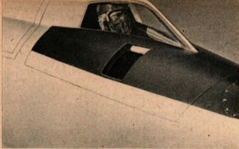
Ci-dessus, on voit la fenêtre latérale qui éclaire le tableau de bord. La photo du dessous montre que le Skyrocket a autant d'instruments sur ce dernier qu'un avion de transport.
