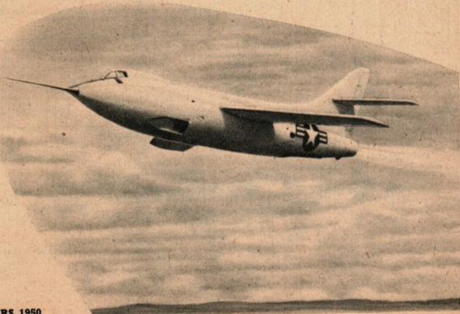
Avec ses quatre fusées auxiliaires en marche, l'avion décolle sur 800 m.
