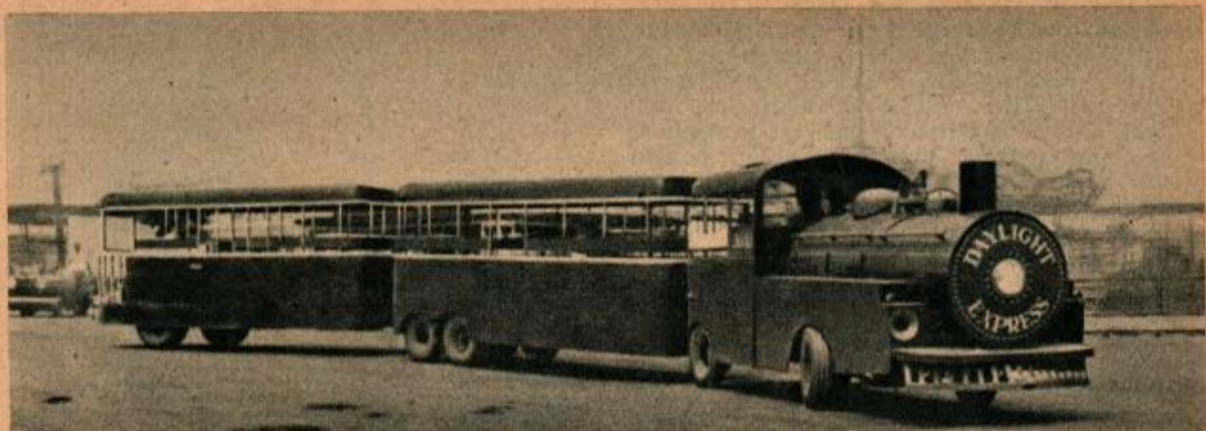
Ci-dessus, une des deux locomotives actionnées par des moteurs de Jeep et que l'on trouve dans le Parc. Celle que l'on voit remorque deux voitures avec des parois en aluminium et des sièges en bois. L'un des accessoires favoris de la clientèle est le système qui actionne la cloche de la locomotive.
