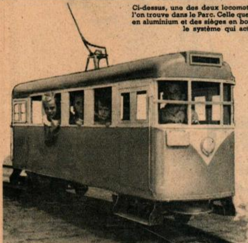
Ci-dessus à gauche, les voyageurs utilisent un tramway en miniature, au poste de commande duquel est assis un enfant qui actionne des organes de commande fictifs. À droite, on voit la ligne aérienne qui alimente le moteur du tramway. Elle vient d'un poteau situé au centre du chemin circulaire que parcourt le véhicule.
