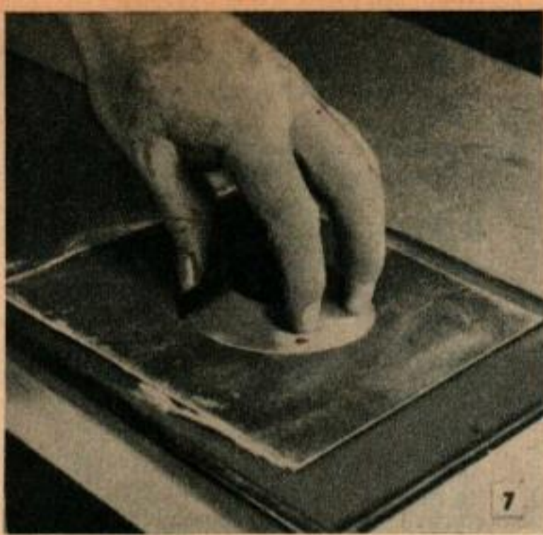
Le bord du tronc de cône est poli et dressé sur un papier ou une toile d'émeri posé sur un marbre. Ceci a pour but d'assurer l'étanchéité de la soudure.
