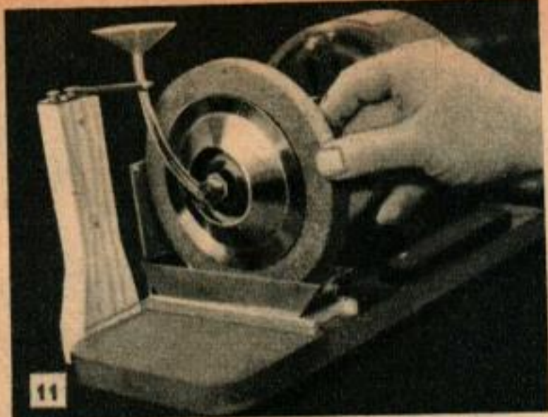
11 Le tube arrive directement dans la meule. Le tube de laiton est placé de façon que son extrémité soit très voisine du disque de laiton.
