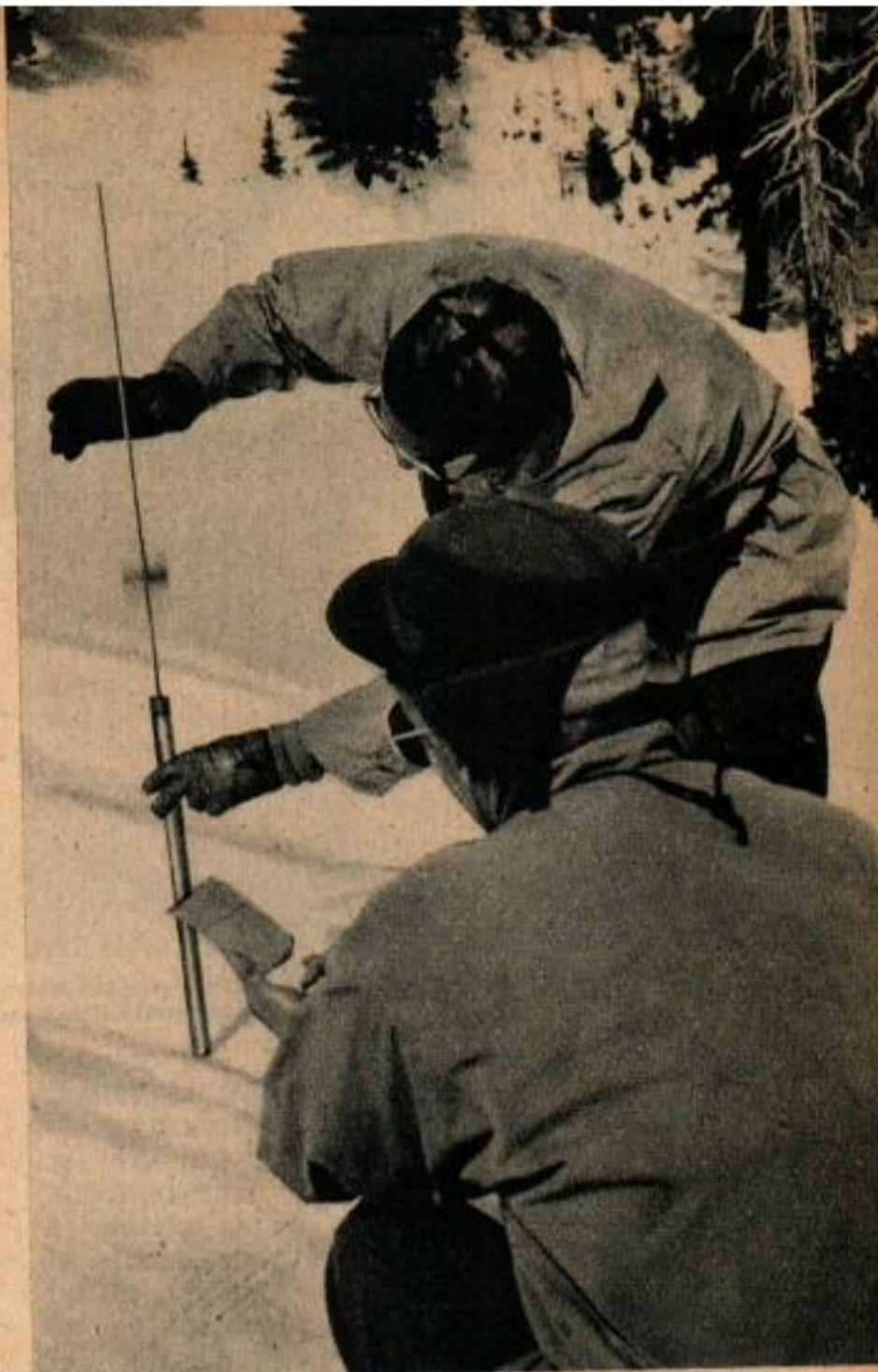
Les experts suisses montrent comment on mesure la résistance de la neige à la pénétration au moyen d'une tige percutante. Ceci est un moyen très utile pour contribuer à la prédiction des avalanches.
