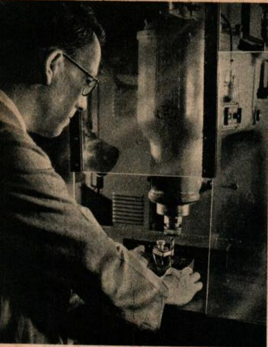
Comment on fait tourner un foret à une vitesse égale à celle des balles de fusil. On a ainsi un outil qui travaille 10 fois plus vite qu'avant. Il suffit de faire une encoche sur les lèvres du foret.
