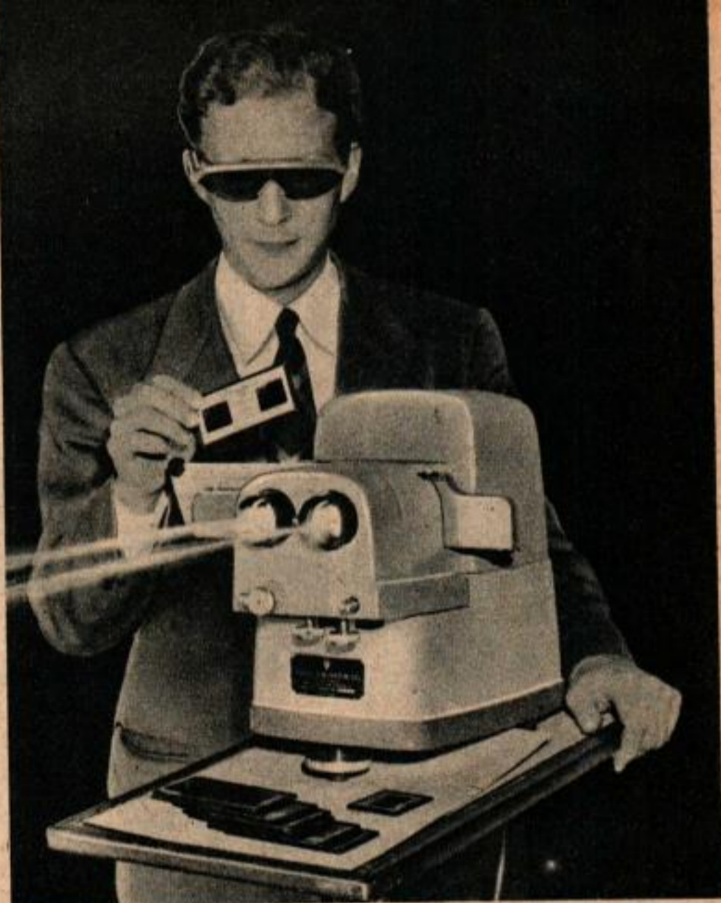
Vue de devant du projecteur montrant les deux objectifs jumelés. On peut s'en servir pour passer les vues planes, il suffit d'éteindre une des ampoules.
