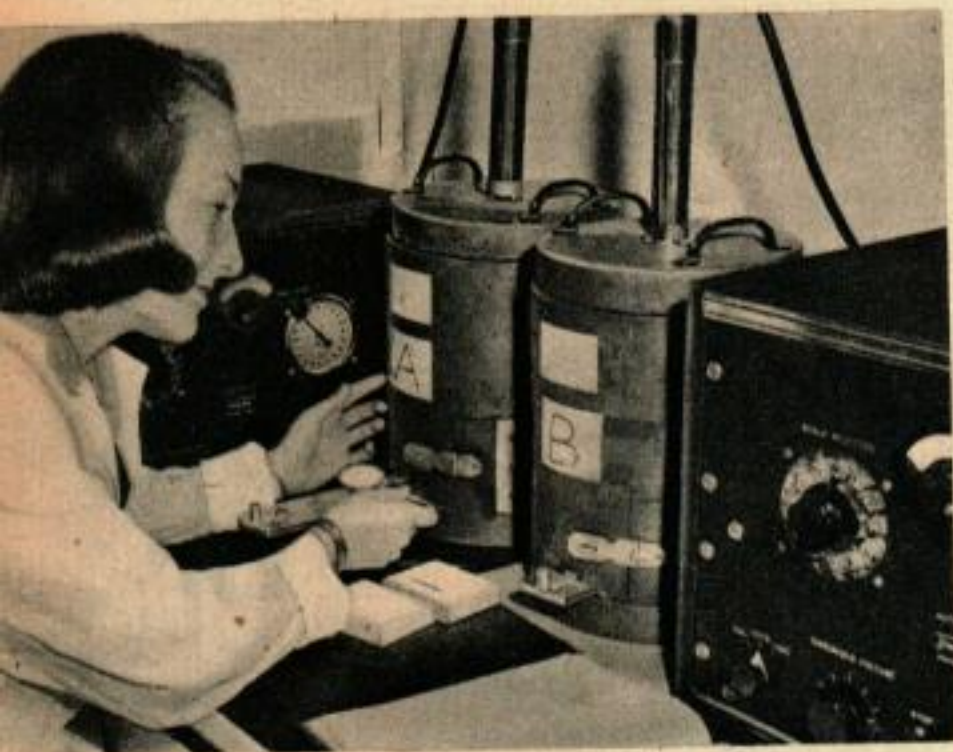
La radio-activité est mesurée en plaçant l'objet étudié dans une boîte de plomb en même temps qu'un compteur de Geiger. Ci-dessous, on recherche la radio-activité des différentes parties du squelette d'un animal.
