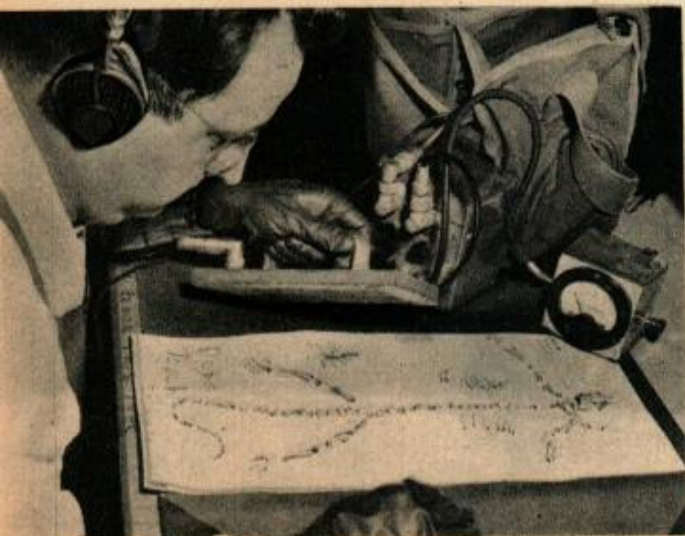
La radio-activité est mesurée en plaçant l'objet étudié dans une boîte de plomb en même temps qu'un compteur de Geiger. Ci-dessous, on recherche la radio-activité des différentes parties du squelette d'un animal.
