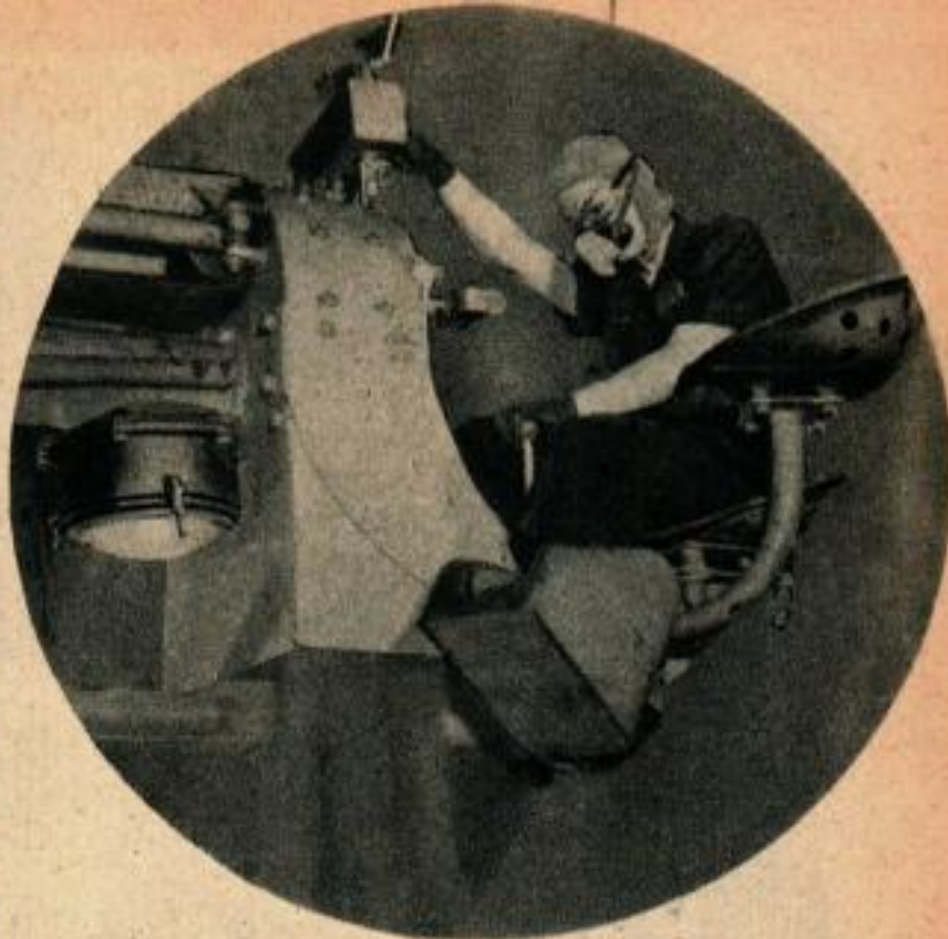
Ci-dessus, cette femme travaille au jet de sable, ce qui l'oblige à porter des lunettes et un masque respiratoire. Ci-dessous, un hygiéniste mesure le bruit que fait un burin pneumatique, afin de voir s'il dépasse le niveau de bruit admissible.
