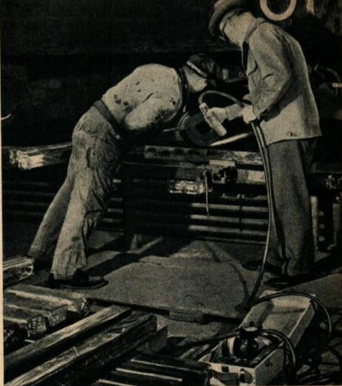
Ci-dessus, un hygiéniste, véritable limier à la poursuite des dangers, recueille un échantillon d'air au voisinage d'une meule basculante. L'air passe dans un flacon d'alcool et dépose ses poussières qui sont comptées ultérieurement au moyen d'un microprojecteur. Ci-dessous on mesure au moyen d'un compteur les radiations émises par une substance contenant des isotopes que l'on fait sortir d'une pile atomique.
