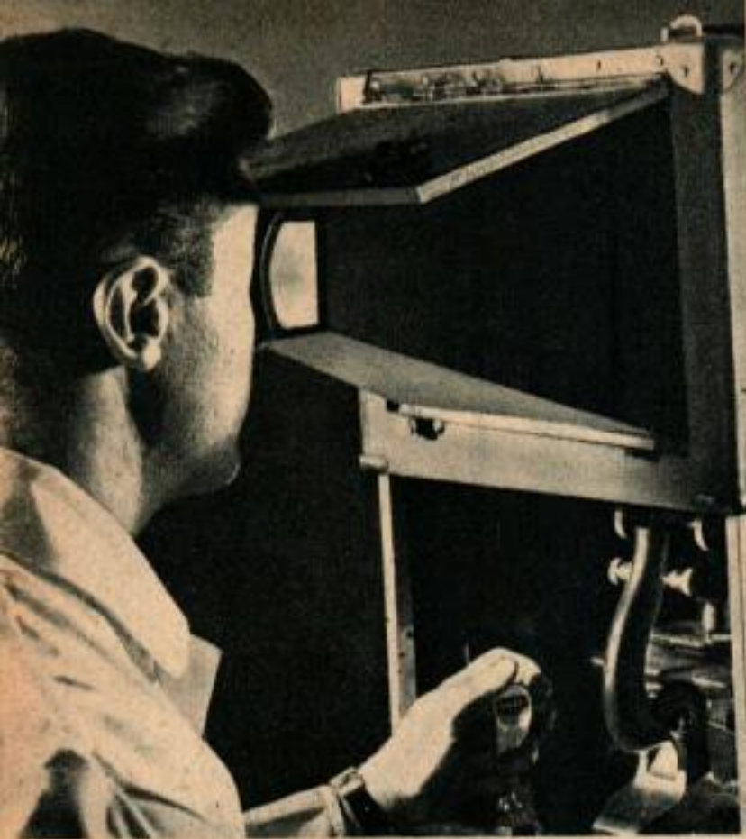
A gauche, on voit l'hygiéniste en train de compter les grains de poussière au moyen d'un microprojecteur. L'image de droite se projette sur un écran de 200 \times 250 permettant un comptage facile. Elle représente les grains de poussière grossis 100 fois.
