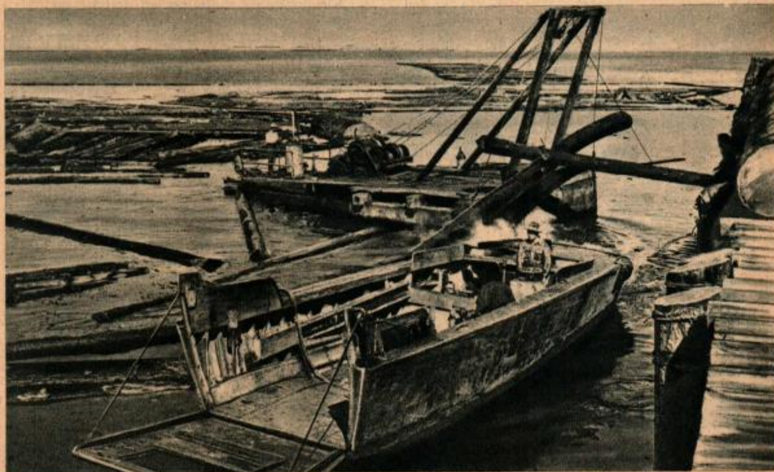
Le scaphandrier utilise le bateau à avant rabattable que l'on voit au premier plan de la photo. Au fond, on voit la grue qui remonte deux troncs récupérés.
