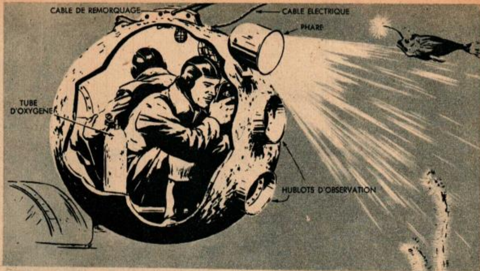
L'intérieur n'est pas particulièrement confortable; la sphère du Dr Barton est prévue pour transporter deux explorateurs sous-marins.
