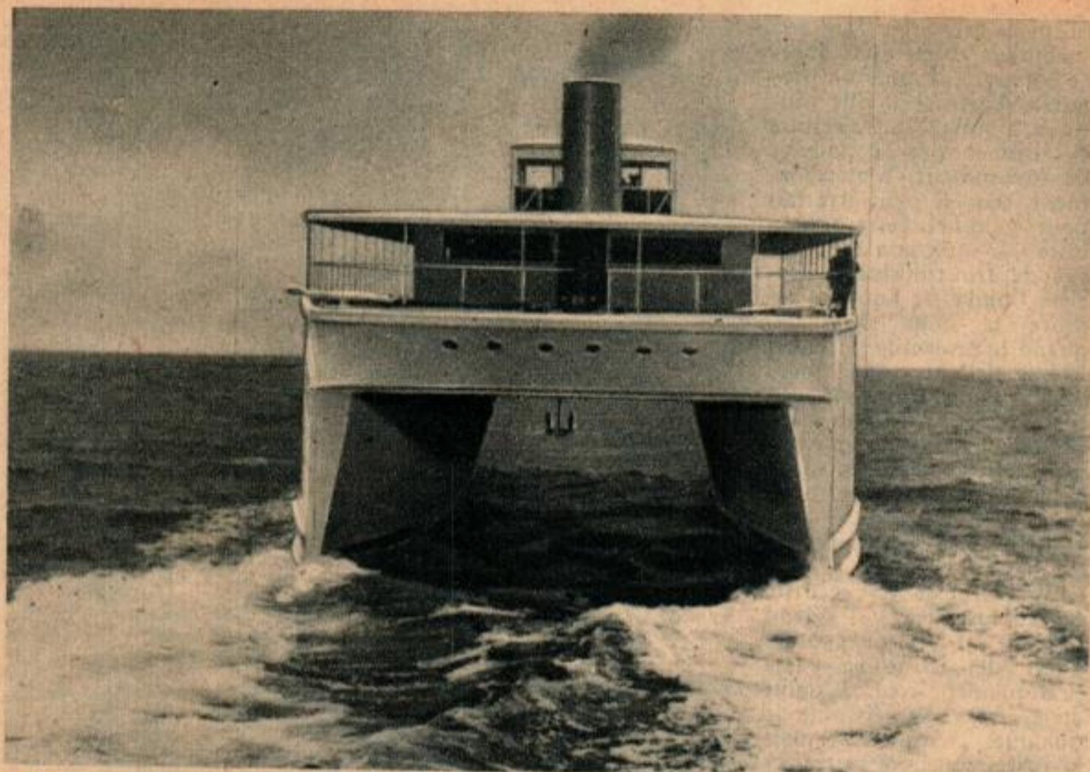
Vue arrière du Venturi de Gar Wood montrant le vaste tunnel entre les coques jumelées. L'air dans le tunnel amortit le navire.
