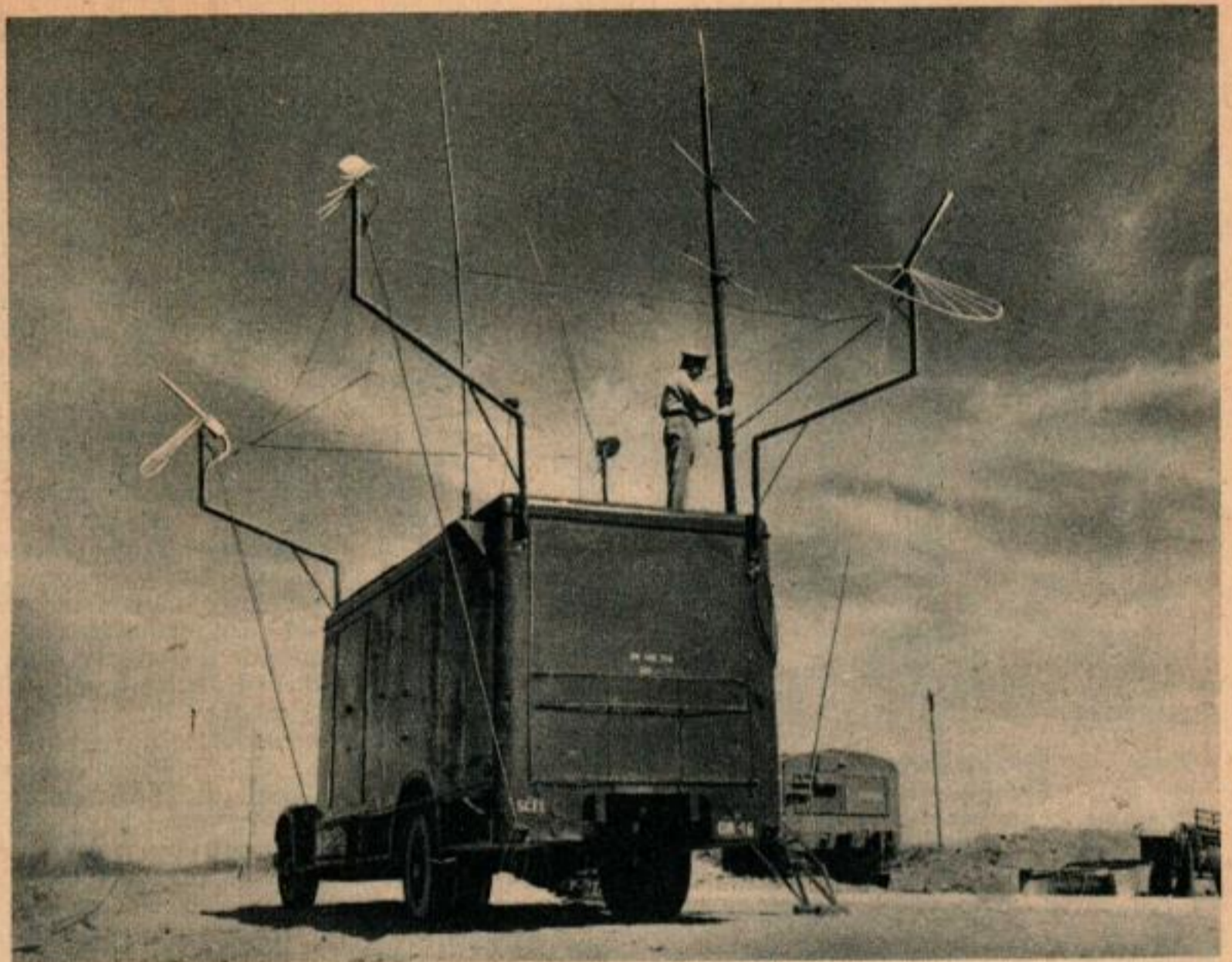
La remorque hérissée d'antennes reçoit ou envoie des signaux à la fusée. Le schéma ci-dessous montre comment la fusée est commandée au cas où elle dévie de sa trajectoire.
