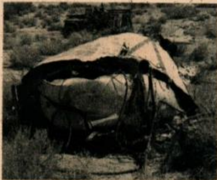
Le corps de la fusée retombe à environ 160 km/h. Bien qu'étant écrasé, il protège les appareils de mesure placés à l'intérieur.
