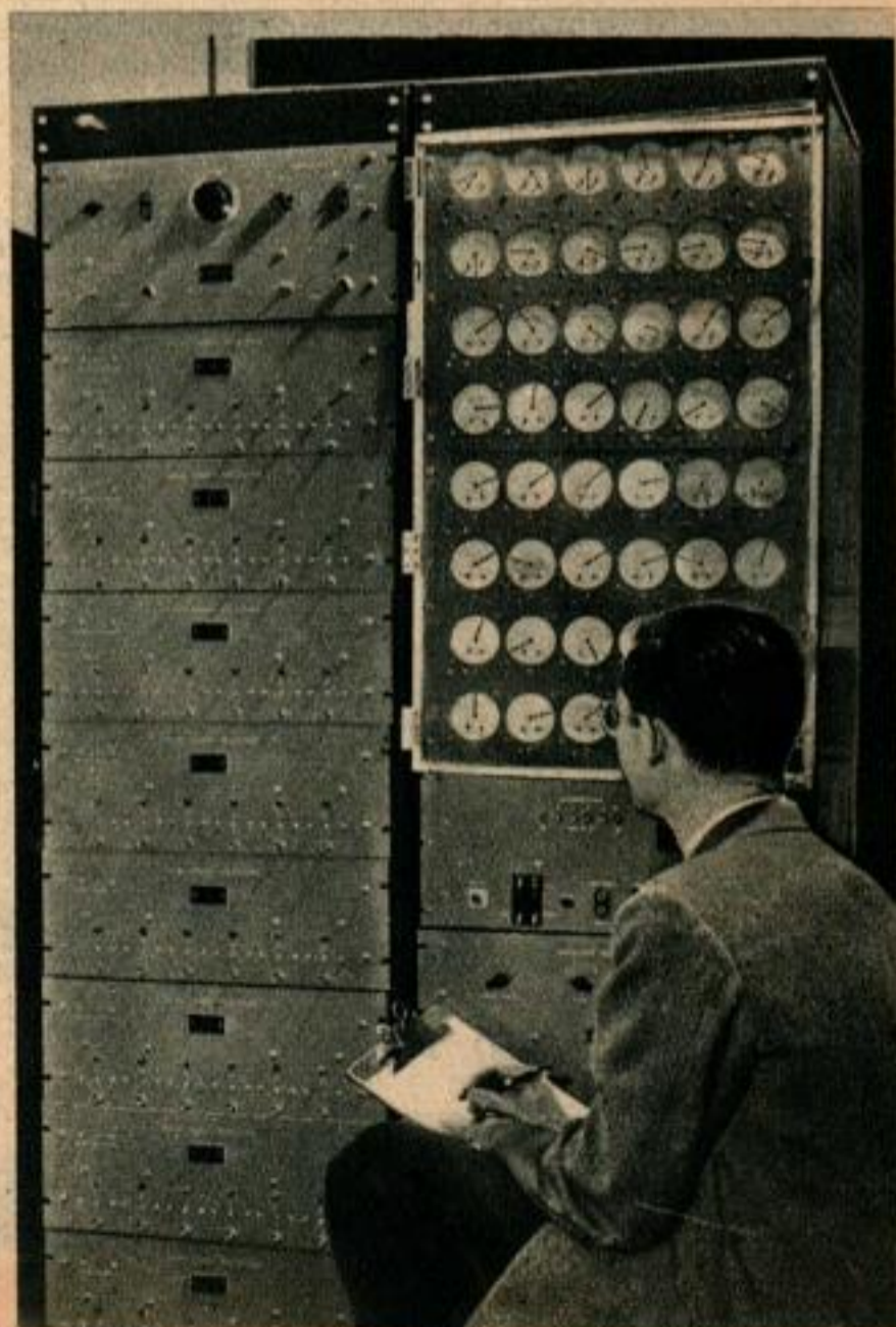
Cet analyseur différentiel à 48 circuits a été construit pour enregistrer les actions des diverses radiations émises par les matières radioactives.
