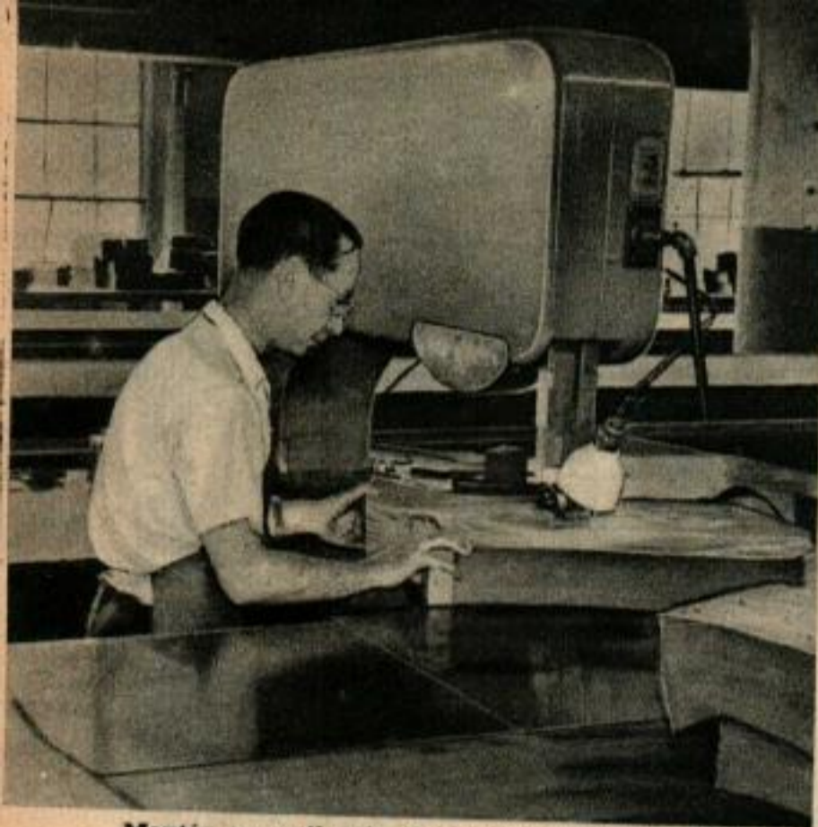
Montée sur rail près de la table de coupe, cette scie est aussi nécessaire dans une fabrique de vêtements qu'une machine à coudre. Elle coupe cent épaisseurs de tissu à la fois.
