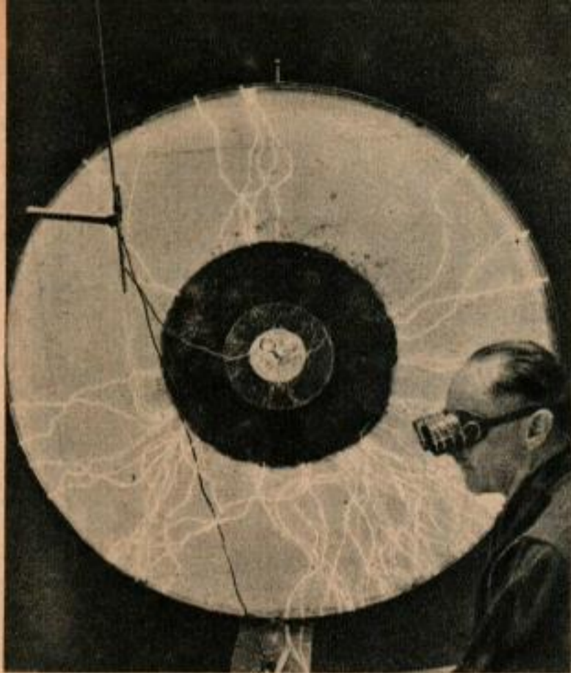
Ci-dessus, l'écran circulaire a un revêtement radioactif qui garde l'image de l'étincelle après le passage du courant. Ci-dessus à droite, 10.000 ampères au moins servent à produire ce feu d'artifice du pyrogeyser. Ci-dessous, le multidistributeur tourne à 1 000 tours-minute pour former des étincelles en forme de plume.
