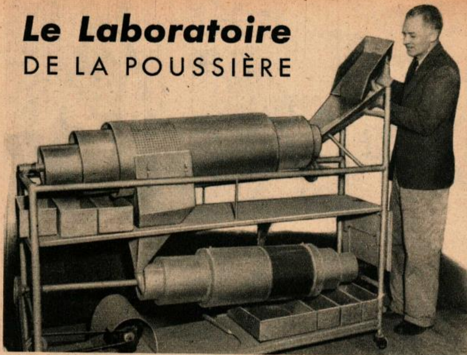
Le sol est classé en 7 tailles pour les essais de résistance au vent par ce séparateur en forme de manche.
