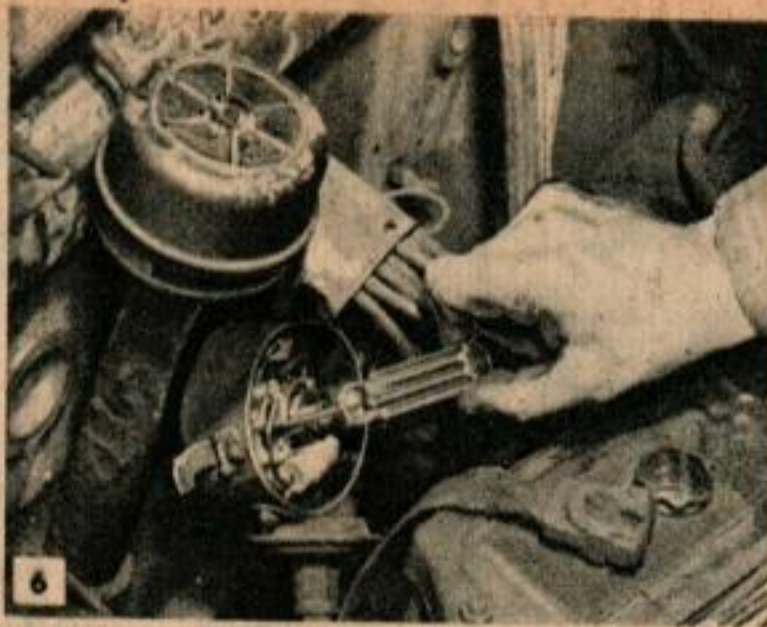
Ci-dessus, réglage de l'écart des pointes du rupteur par desserrage de la vis du plateau et déplacement de l'excentrique. Ci-dessous, noter l'accumulation de poussière sur l'extérieur du filtre à air.
