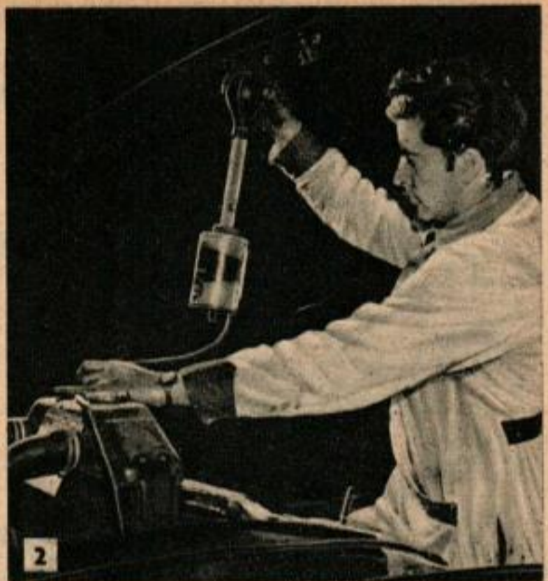
Avec un densimètre spécialement adapté à cet usage, on vérifie que le point de congélation du liquide du radiateur est suffisamment bas.
