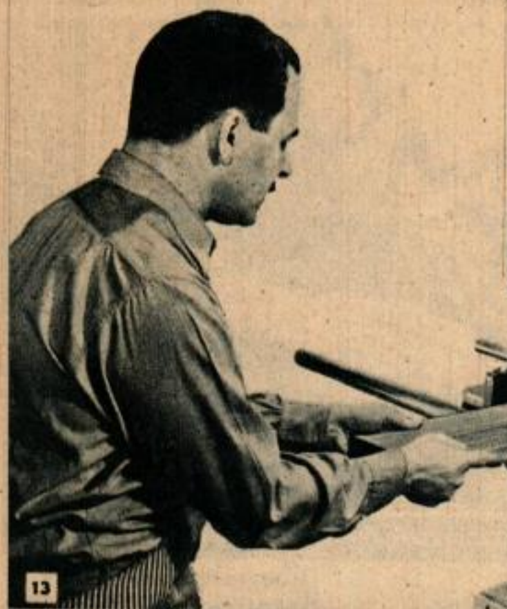
Sciage en tirant: méthode simple et sûre, souvent utilisée dans les ateliers pour scier des planches de grande longueur.
