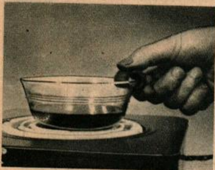
Des pinces pour prendre les récipients sans se brûler avec de petits bouts de tuyau de caoutchouc. On les fend afin de pouvoir les placer à cheval sur le bord des vases.
