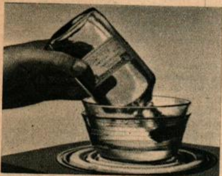
Les bouchons des flacons renfermant des produits fortement volatils sont scellés en les plongeant dans une solution chaude formée de 10 g de colle forte, 6 cm 3 d'eau et 8 gouttes de glycérine.
