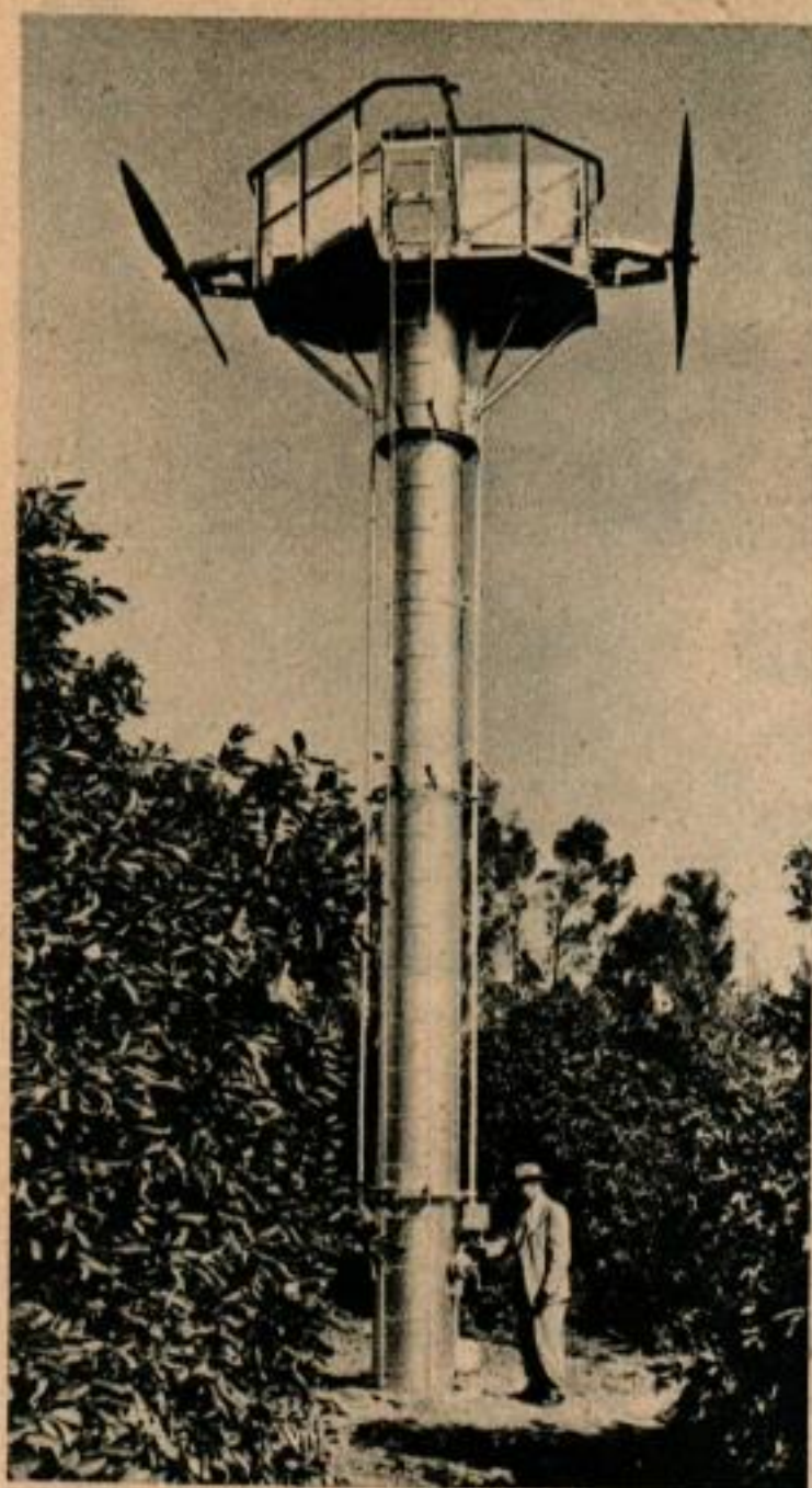
Une machine à vent rabat l'air chaud supérieur sur les arbres. Ci-dessous, une couche de neige protège le fruit de la gelée, mais les brûleurs sont allumés en cas de forte gelée.
