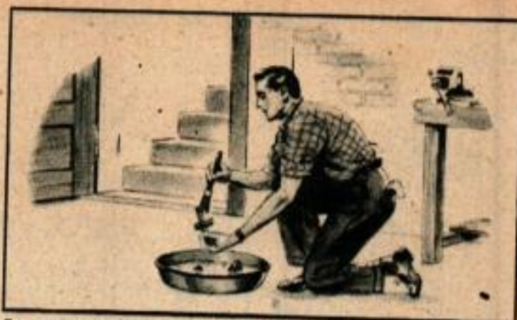
Le nettoyage de petites pièces de mécanique peut parfaitement se faire à l'intérieur si une ventilation abondante est assurée.
