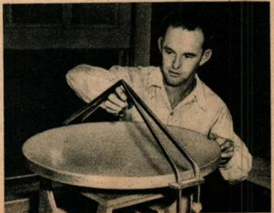
Ci-dessus, cet abaque d'impédance compliqué sert à mesurer les caractéristiques électriques des antennes. Ci-dessous un ouvrier règle un guide d'onde qui émet des ondes radio renvoyées vers le haut par le réflecteur parabolique pour des essais de réflexion dans l'atmosphère.
