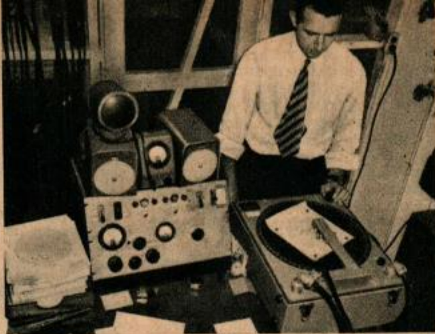
Le stylet à l'extrémité du bras mobile inscrit le diagramme de rayonnement des antennes sur un graphique fixé à la table tournante. Sur ce graphique représenté à gauche, l'effet du masque de la superstructure du navire est très apparent.
