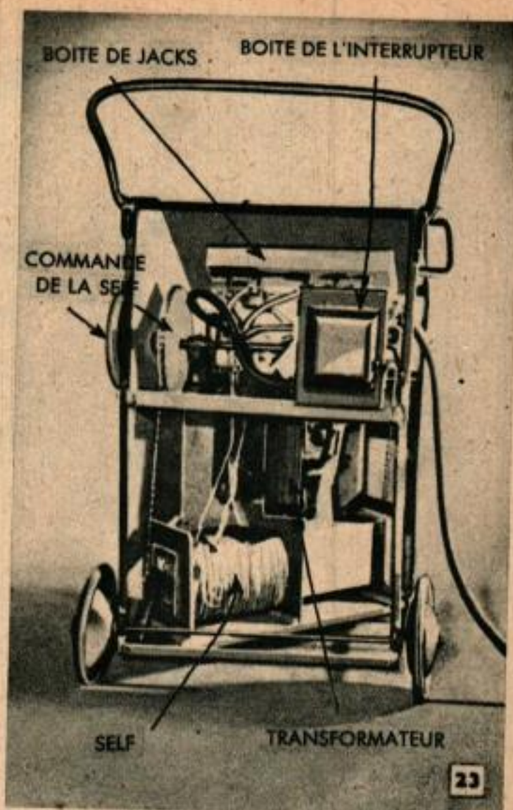
L'installation est montée sur un châssis à deux roues qui facilite le déplacement dans l'atelier.
