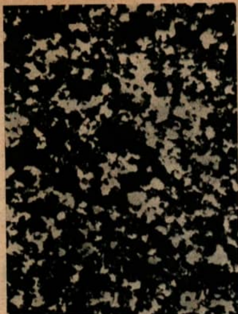
À gauche, image vue au microscope électronique (à droite) de la couche d'oxyde formée sur le nickel à une température de 480°.
