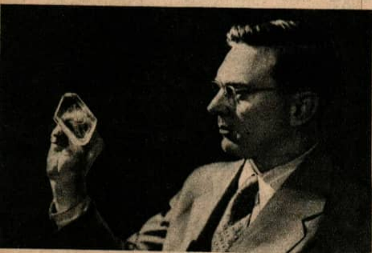
Ce cristal de sulfate de lithium pèse 340 g. Ces cristaux sont utilisés dans les armes sous-marines. La croissance d'un tel cristal demande 23 jours. En bas, une tuyère de soufflerie munie de miroirs servant à la photographie des ondes de choc produits par les projectiles supersoniques.
