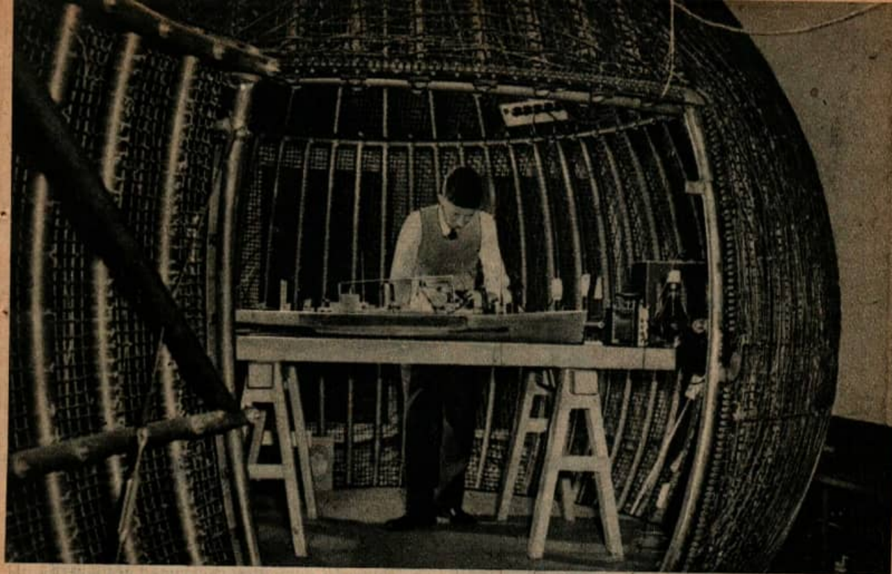
Dans cette «cage à oiseaux», comme on l'appelle familièrement, les expérimentateurs créent à volonté tous les champs magnétiques possibles dans le but de neutraliser les mines ennemies. Les savants de White-Oak étudient tout ce qui fait du bruit ou du dégât au-dessus ou au-dessous de la surface des eaux.
