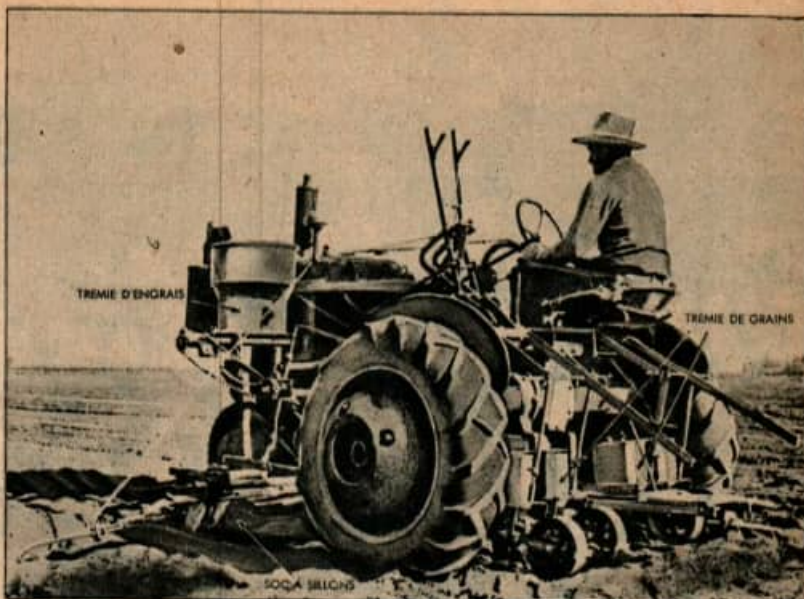
Ce tracteur combine plusieurs machines en une seule car il permet en une seule opération de répandre de l'engrais sur 4 rangées, de creuser les sillons et d'ensemencer.
