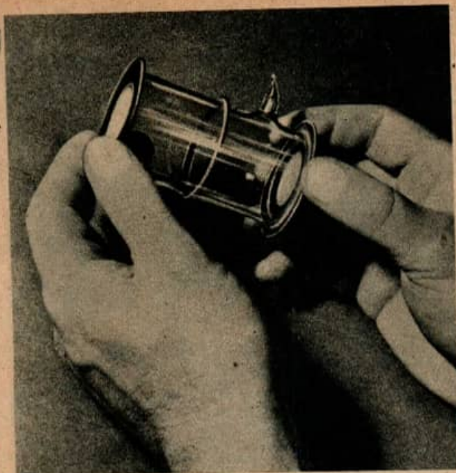
Dans ce petit tube est d'abord réalisée l'augmentation de luminosité de l'image donnée par rayons X. C'est une transformation quadruple: rayons X — rayons lumineux — électrons — rayons lumineux qui donne une image à grande luminosité sur le petit écran.
