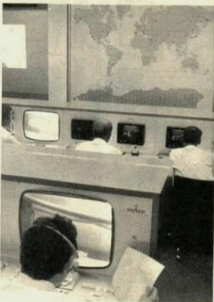
Salle de commande du centre opérations satellite ouest-allemand de Oberpfaffenhofen, Haute-Bavière. Les techniciens peuvent, grâce aux équipements les plus modernes, suivre l'orbite du satellite de recherche « Azur » et prendre très rapidement d'importantes décisions. La planisphère installée devant les consoles de commande signale, par exemple, automatiquement, l'attitude du satellite.
