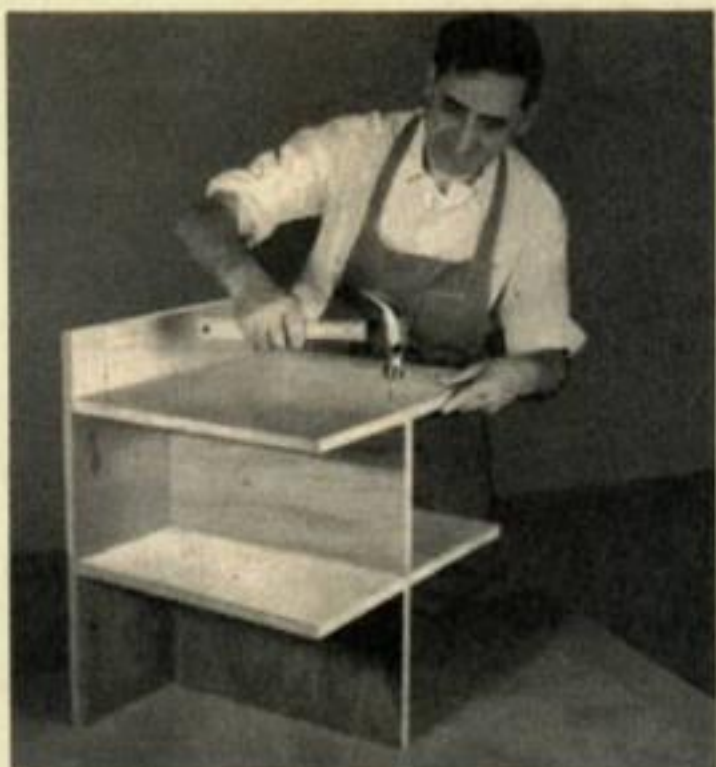
L'assemblage se fait avec des joints en bout collés et cloués. Enfoncer les pointes et boucher au mastic.
