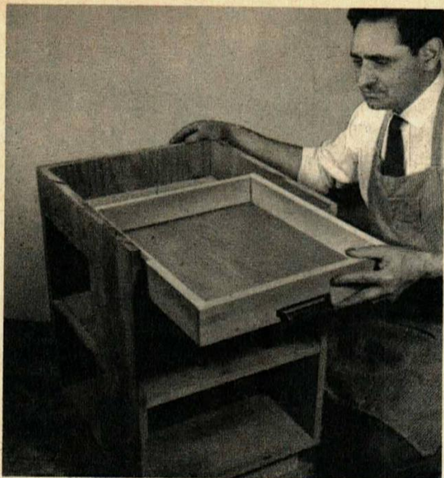
Un tiroir peu profond s'adapte au logement supérieur. Il glisse facilement grâce au jeu laissé par côté et un peu de cire.
