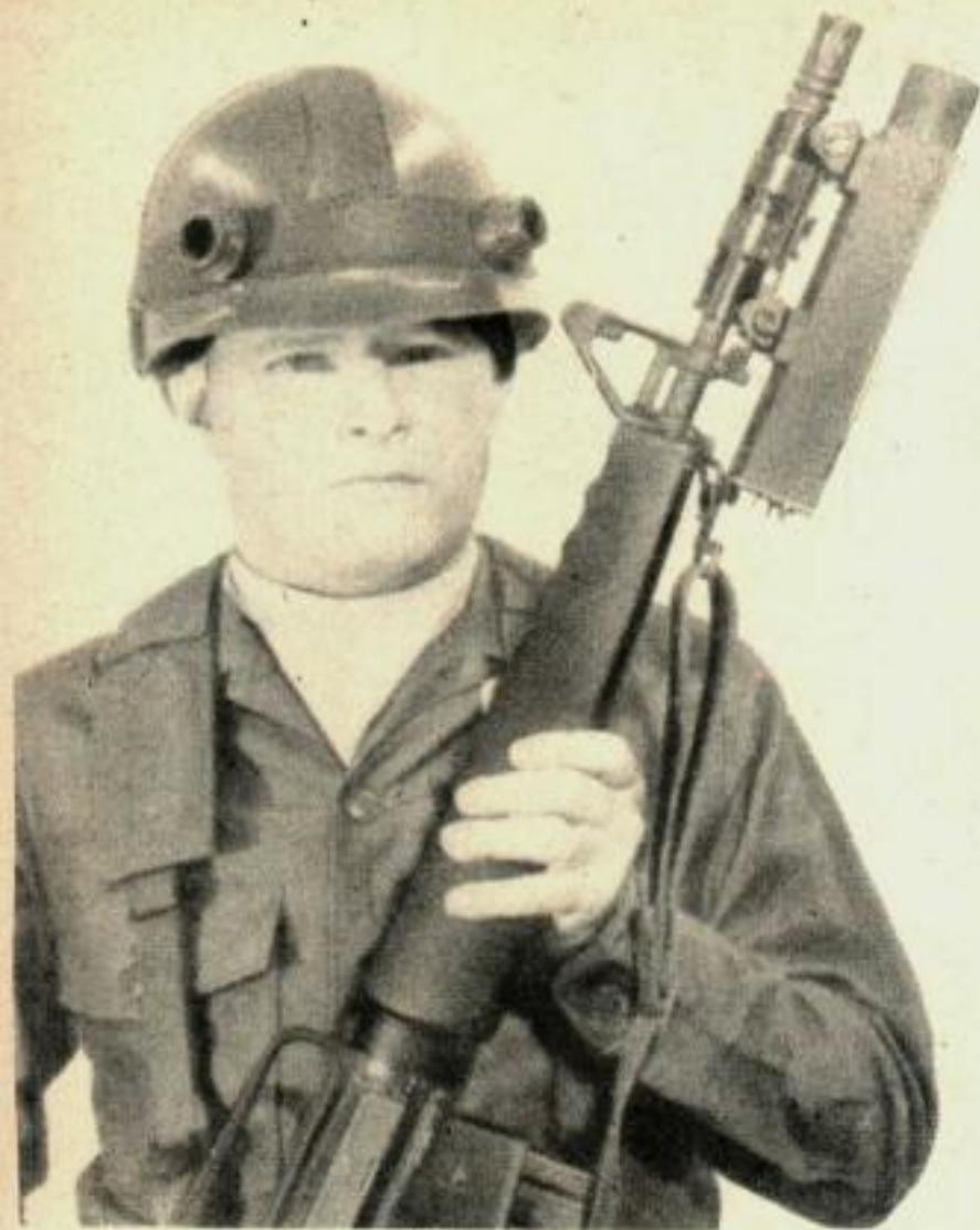
Le fantassin porte un émetteur de rayon laser pesant moins d'un kilo, quatre détecteurs sur son casque et quatre autres détecteurs sur son corps.
