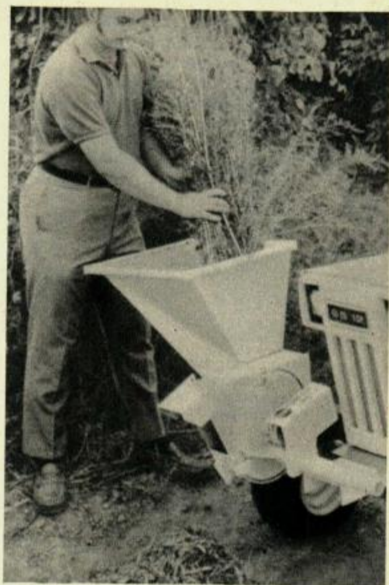
Un broyeur tous usages peut être amené à pied d'œuvre, et animé par le moteur conçu pour les modèles Sears « Suburban », « SS-12 » et « Hydro-Trac ». La benne de chargement montée à l'avant (cliché du haut à gauche) soulève 225 kg à une hauteur de 1,62 m. Elle est idéale pour les petits travaux. Elle est commandée hydrauliquement sur le « Power King ». Cet alternateur monté sur tracteur fournit 115 volts là où on en a besoin. Il permet de faire marcher des outils, des pompes, etc. Son prix oscille entre 185 et 245 dollars selon le nombre de watts désiré.
