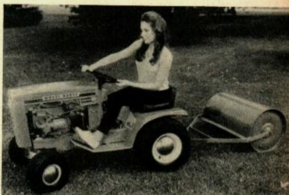
Ce rouleau d'un diamètre de 70 cm, pesant 187 kg, une fois rempli d'eau suit docilement le tracteur. 57 S.
