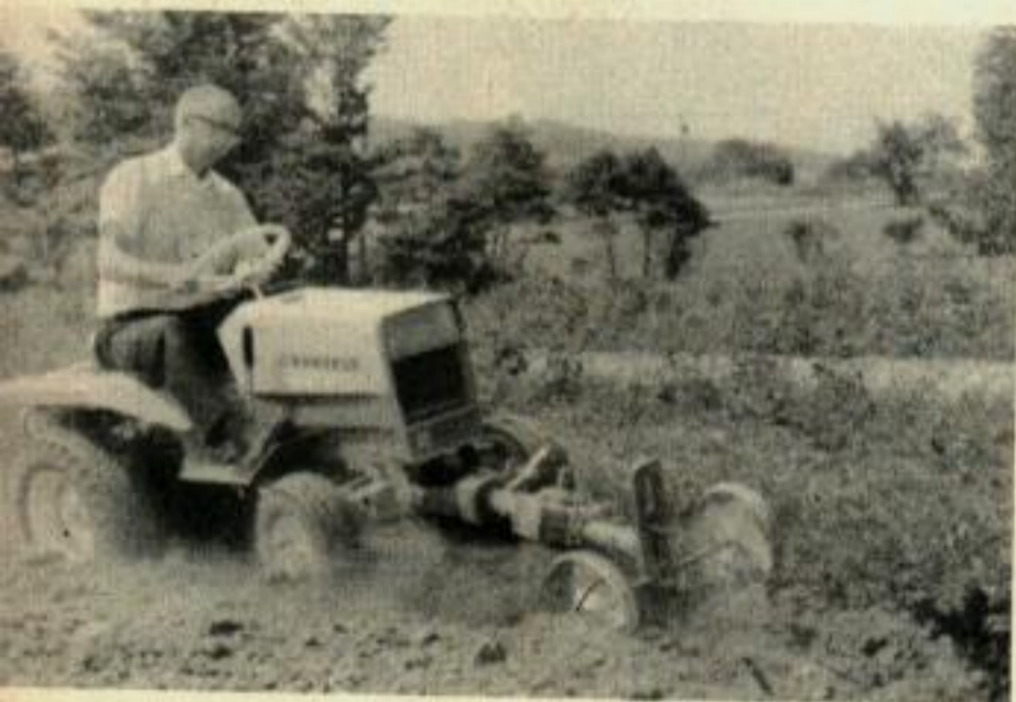
Cette bineuse à lames multiples est produite en trois largeurs : 62 cm, 75 cm, 82 cm. Elle coûte environ 275 $.
