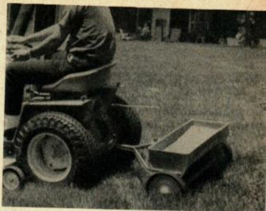
Cette semeuse pour pelouse, 75 cm de largeur, et une capacité de 38 kg. Le levier placé sous le siège du tracteur interrompt ou réamorçe les semailles.
