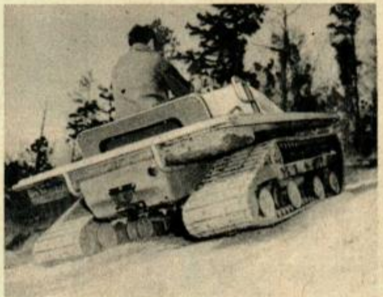
La « Machine Verte » marche sur la neige profonde sans s'enfoncer. Les chenilles ne dérapent pas sur le verglas.
