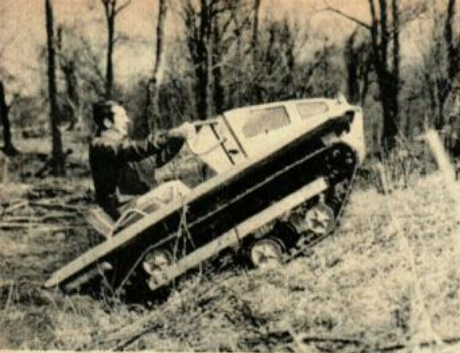
Le véhicule tout-terrains d'OMC escalade les talus couverts de buissons et de souches. Si le fond ne touche pas, les chenilles en caoutchouc peuvent franchir les souches.
