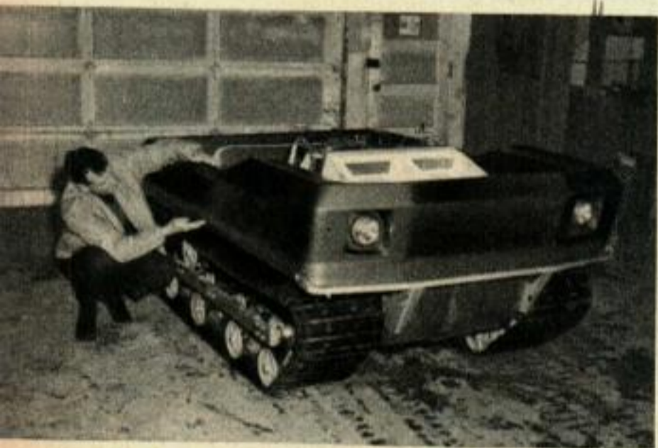
On peut augmenter le franc-bord de 30 cm en montant des panneaux supplémentaires qui se vissent sur les côtés de la caisse.
