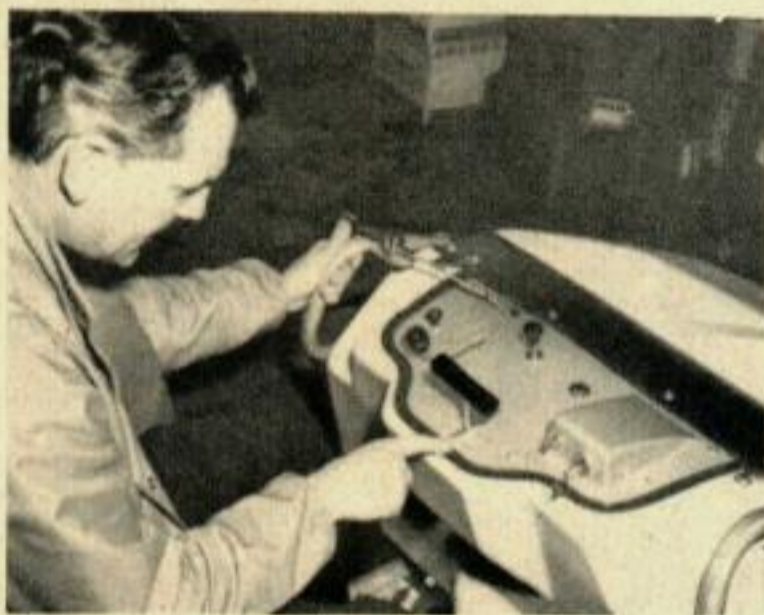
L'ensemble des manœuvres est commandé par un seul levier, en forme de « T », situé sur le tableau de bord, juste en face du conducteur.
