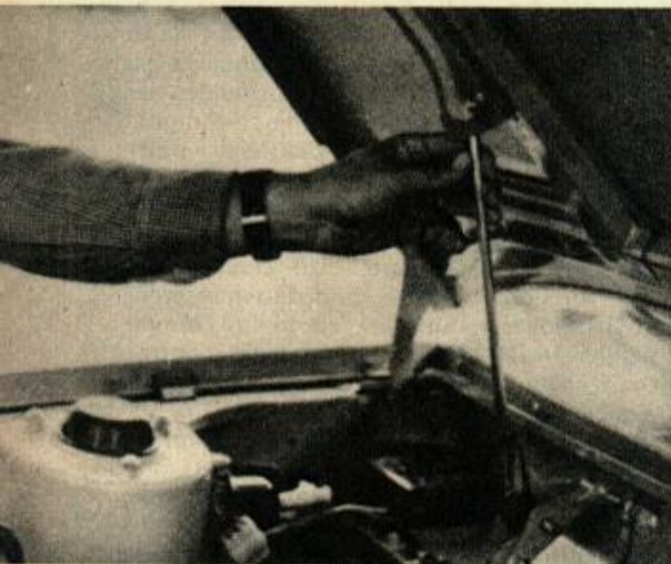
La béquille maintenant le capot se met en place automatiquement lorsqu'on soulève celui-ci mais il faut la tirer à soi pour le rabattre. La malle bien conçue est généreuse.
