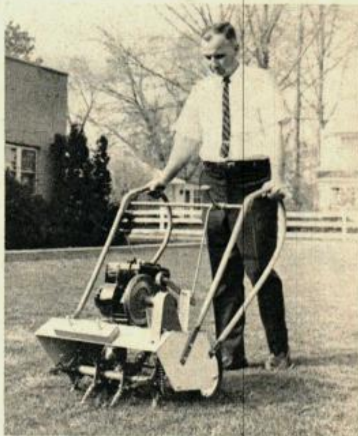
Cette machine à aérer possède des « cuillers » qui arrachent les morceaux de terre, comme l'indique le schéma ci-dessus.
