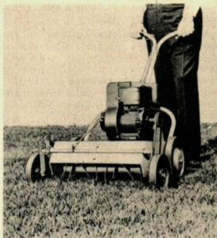
Cette « tondeuse verticale » coupe les brins d'herbe morts à l'aide de huit lames en acier flexible trempé à l'huile.
