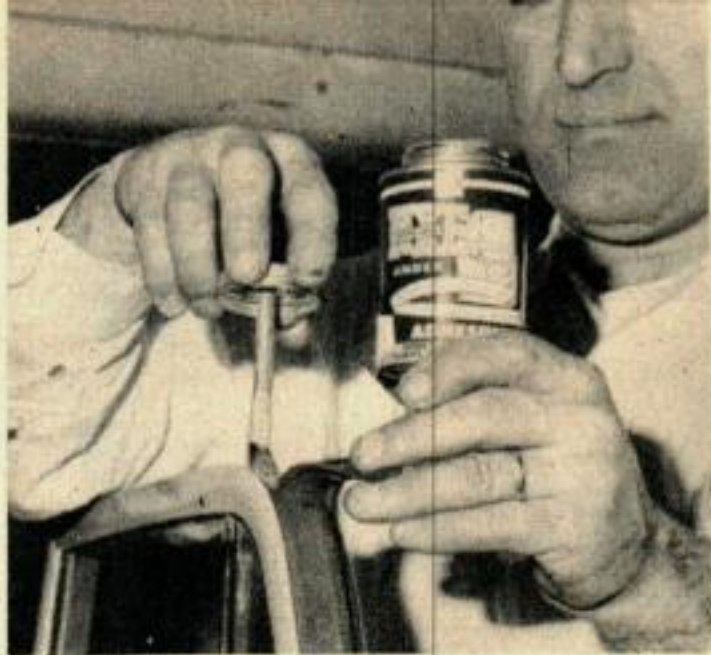
Le profilé d'étanchéité qui s'est desséché et détérioré est remplacé au moyen d'un adhésif.
