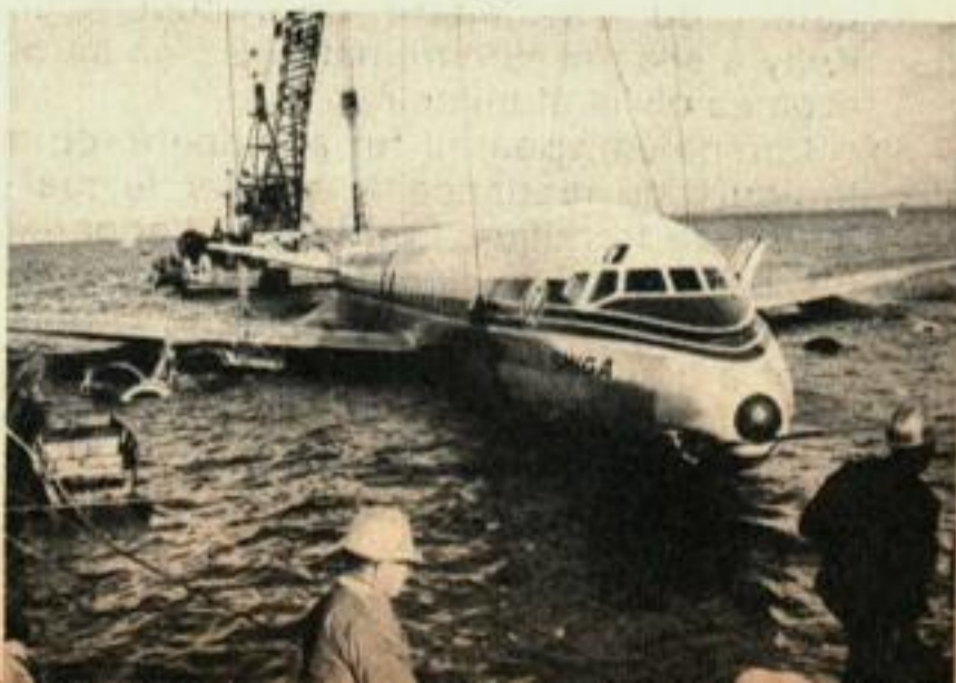
Les poutres de levage sont placées sous les ailes et les grues flottantes commencent à soulever l'appareil.
