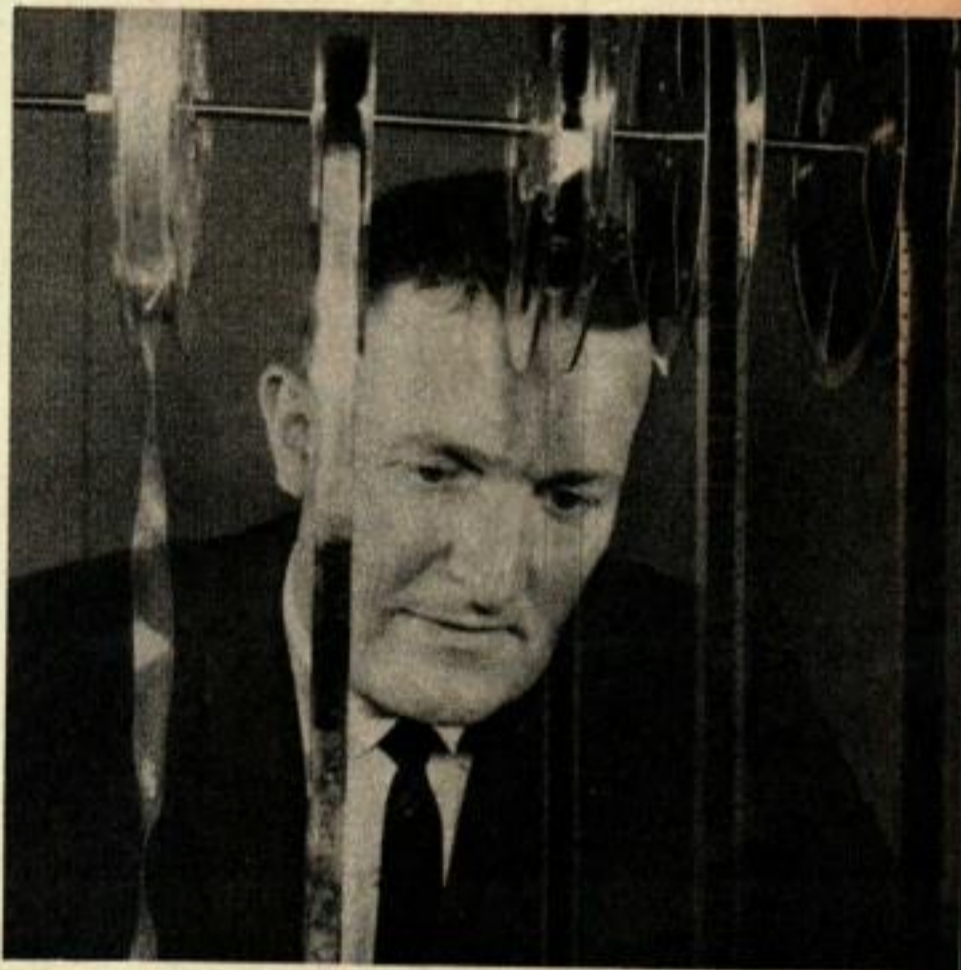
William Hannan examinant les cinq stades de la fabrication du ruban de vinyl utilisé dans le système RCA. De gauche à droite le film original, sa copie holographique, le ruban comportant des aspérités obtenues par un bain spécial, la matrice en nickel réalisée par l'électrolyse de ce ruban, et la bande de vinyl que la matrice a pressé comme un vulgaire disque.
