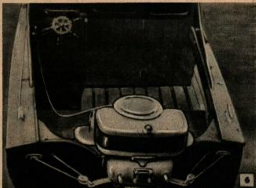
À gauche, méthode de liaison du câble de commande à la barre arrière du gouvernail. Les poulies sont montées sur la barre et dans l'arrière. Ci-dessus, la barre de gouvernail est fixée dans ce moteur sous le carter.
