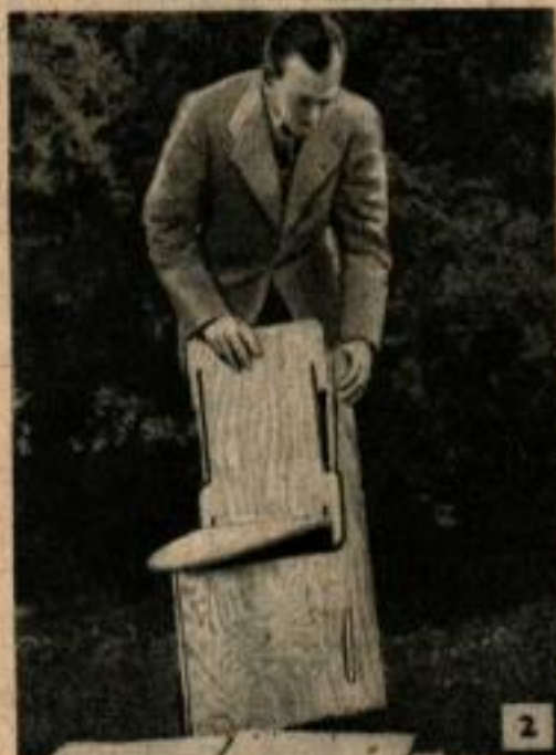
La chaise se monte en une seconde. Il suffit d'ouvrir les côtés, de lever le siège, d'insérer le dossier dans les fentes et de le pousser vers le bas pour faire tenir les pièces entre elles.
