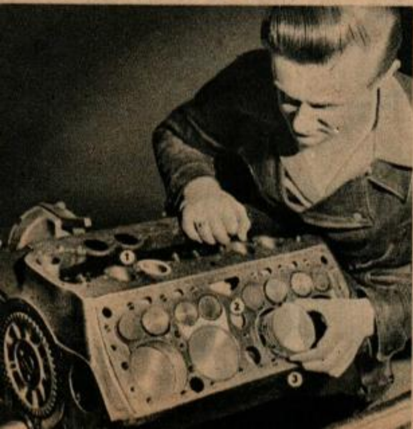
Moteur courant de V-8 remanié pour donner plus de puissance et moins de consommation. Il a un double carburateur et un système d'allumage complètement refait.
