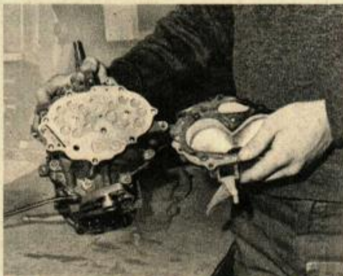
8. En enlevant le carter d'admission, on accède aux clapets, eux-mêmes démontables par une simple vis.
