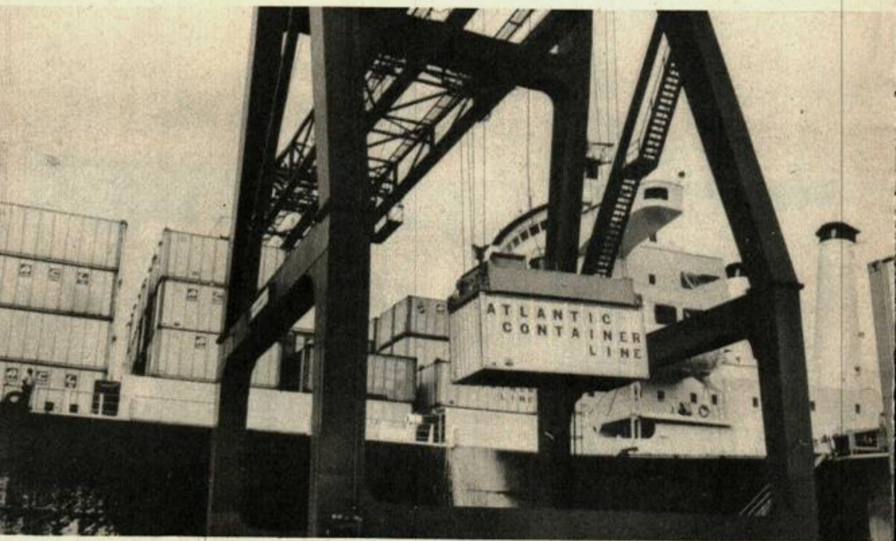
Cette énorme grue soulève un container de 32 tonnes comme si c'était une caisse d'oranges et le pose doucement sur le pont du bateau. Les deux grues du port peuvent être déplacées d'un point à un autre sur des rails.
