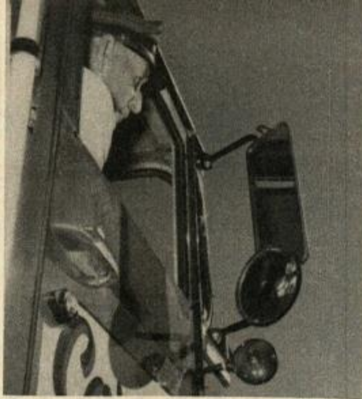
Le double rétroviseur sur le côté droit de la cabine réduit les angles morts. Le miroir ordinaire et le miroir convexe permettent de voir au loin et à côté.
