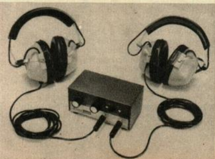
Ces commandes à distance vous permettent de brancher le casque et de régler le volume et la tonalité sans vous lever de votre siège. Les modèles sont (de gauche à droite à partir du bas): Realistic, Superex, Koss T5, Koss T-10, Allitd et (au milieu) Heathkit. Les autres accessoires sont un transformateur adaptateur d'impédance (en bas au milieu) et un cordon adaptateur à double fiche.
