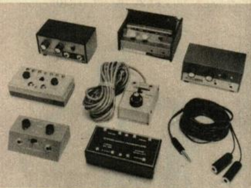
Ces commandes à distance vous permettent de brancher le casque et de régler le volume et la tonalité sans vous lever de votre siège. Les modèles sont (de gauche à droite à partir du bas): Realistic, Superex, Koss T5, Koss T-10, Allitd et (au milieu) Heathkit. Les autres accessoires sont un transformateur adaptateur d'impédance (en bas au milieu) et un cordon adaptateur à double fiche.
