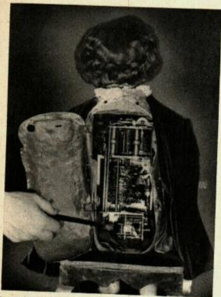
La colonne vertébrale de « l'écrivain » est formée de cames et leviers qui contrôlent les mouvements du poignet traçant les lettres.
