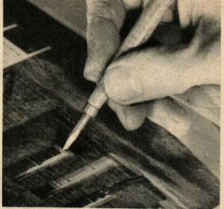
Cette pointe sèche fabriquée avec un taraud permet de nettoyer des clichés en enlevant les poussières d'argent.
