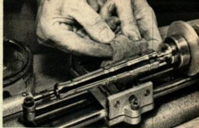
Le canon terminé est poli sur le tour avec une pâte à polir. La boule terminale est finie à la main par la suite.
