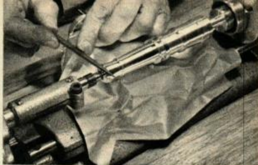
Une fois que les arêtes ont été usinées, les arrondir avec une lime « suisse », comme on le voit sur la photo, à l'extrémité de la bouche.
