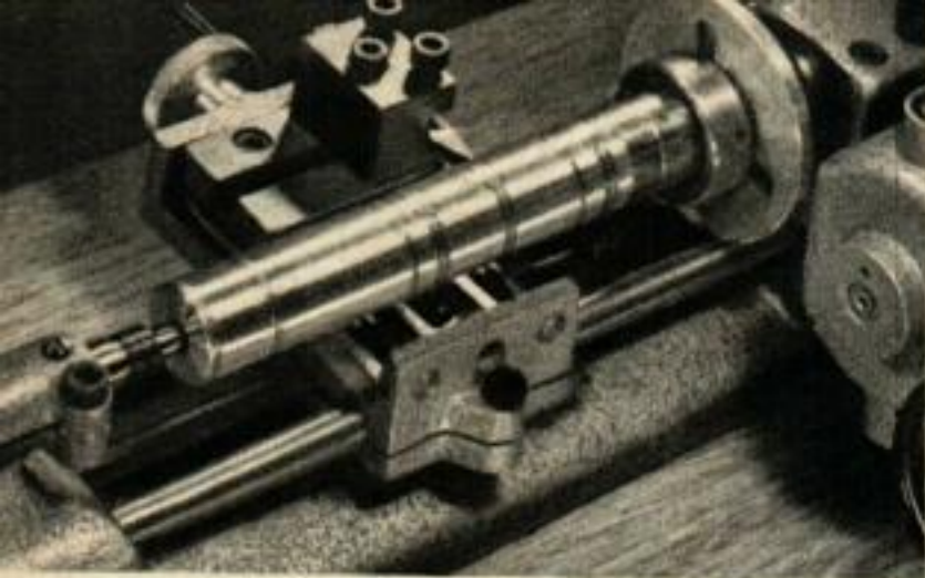
L'ébauche du canon, montée entre deux points, est menée par un plateau à griffes constitué par le segment extérieur d'un roulement à billes.
