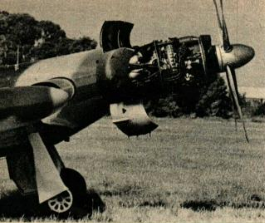
Le « Mustang III » équipé d'un turbopropulseur Rolls-Royce « Dart ». Le capot s'ouvre en pétales permettant un accès facile aux organes-moteur.
