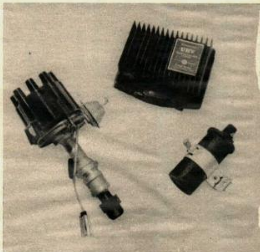
Distributeur à pulsation magnétique. Supprime l'usure du distributeur classique.
