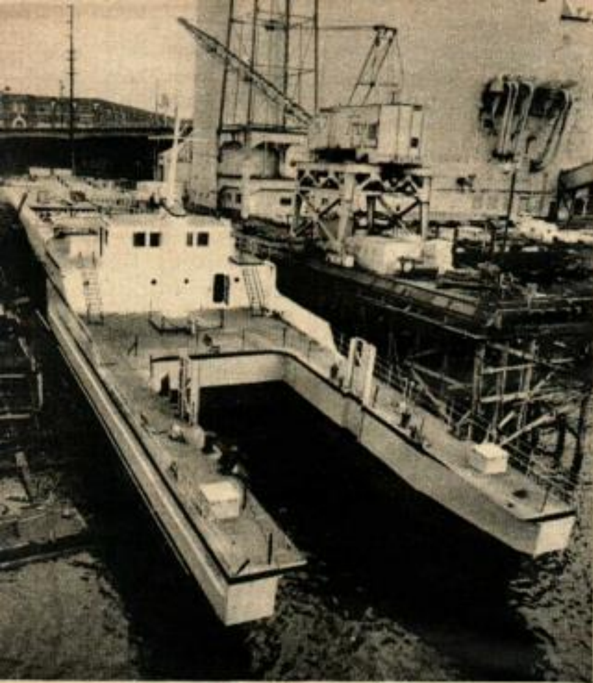
Le Transquest, bâtiment de support logistique du Deep Quest. Le monte-charge est en position basse, l'arrière formant bassin ouvert dans lequel le sous-marin peut manœuvrer.
